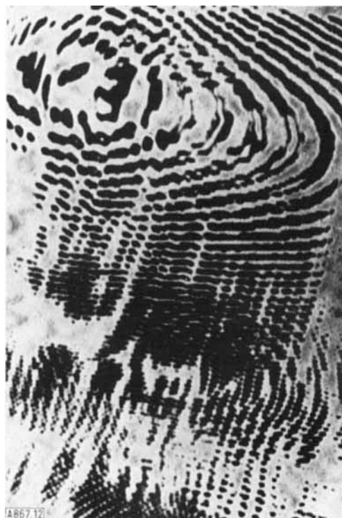
Abb. 12. Akustisches Hologramm eines 13 mm-Schraubenbolzens mit etwa 4 Windungen je cm.
