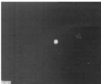
Abb. 10. Aus dem akustischen Hologramm eines Streupunktes mittels des in Abb. 9. gezeigten Abbildungssystems erhaltenes Bild.
